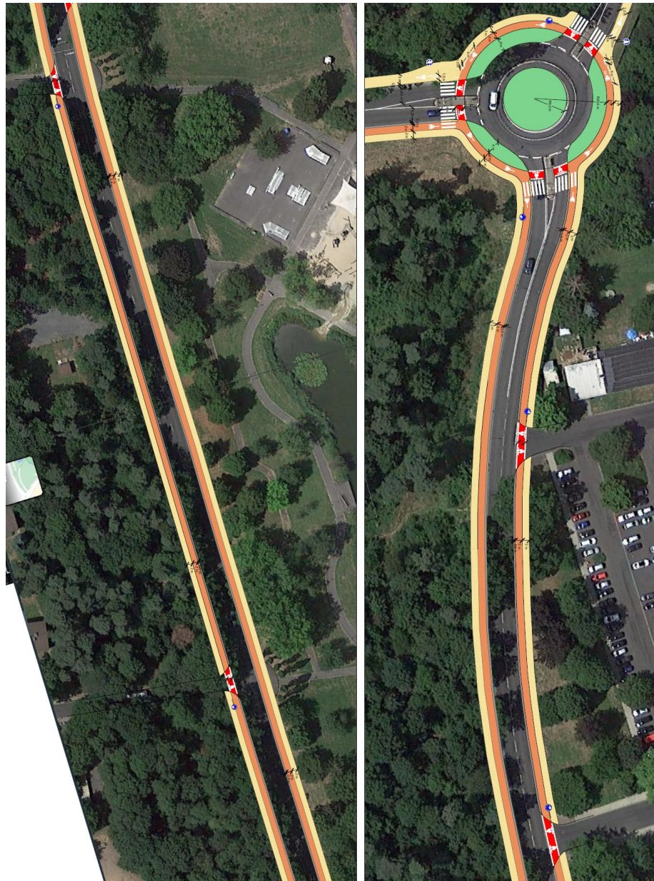
Abbildung 9-2: Vorentwurf für die Radverkehrsführung auf der Waldstraße und am Kreisverkehr Rheinstraße
