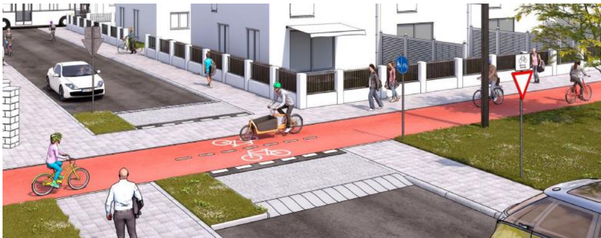
Abbildung 122: Konzeptdarstellung einer exemplarischen Maßnahme mit bevorzugter Straßenüberführung für den Radverkehr (vgl. BMDV, 2022a, S. 7)
