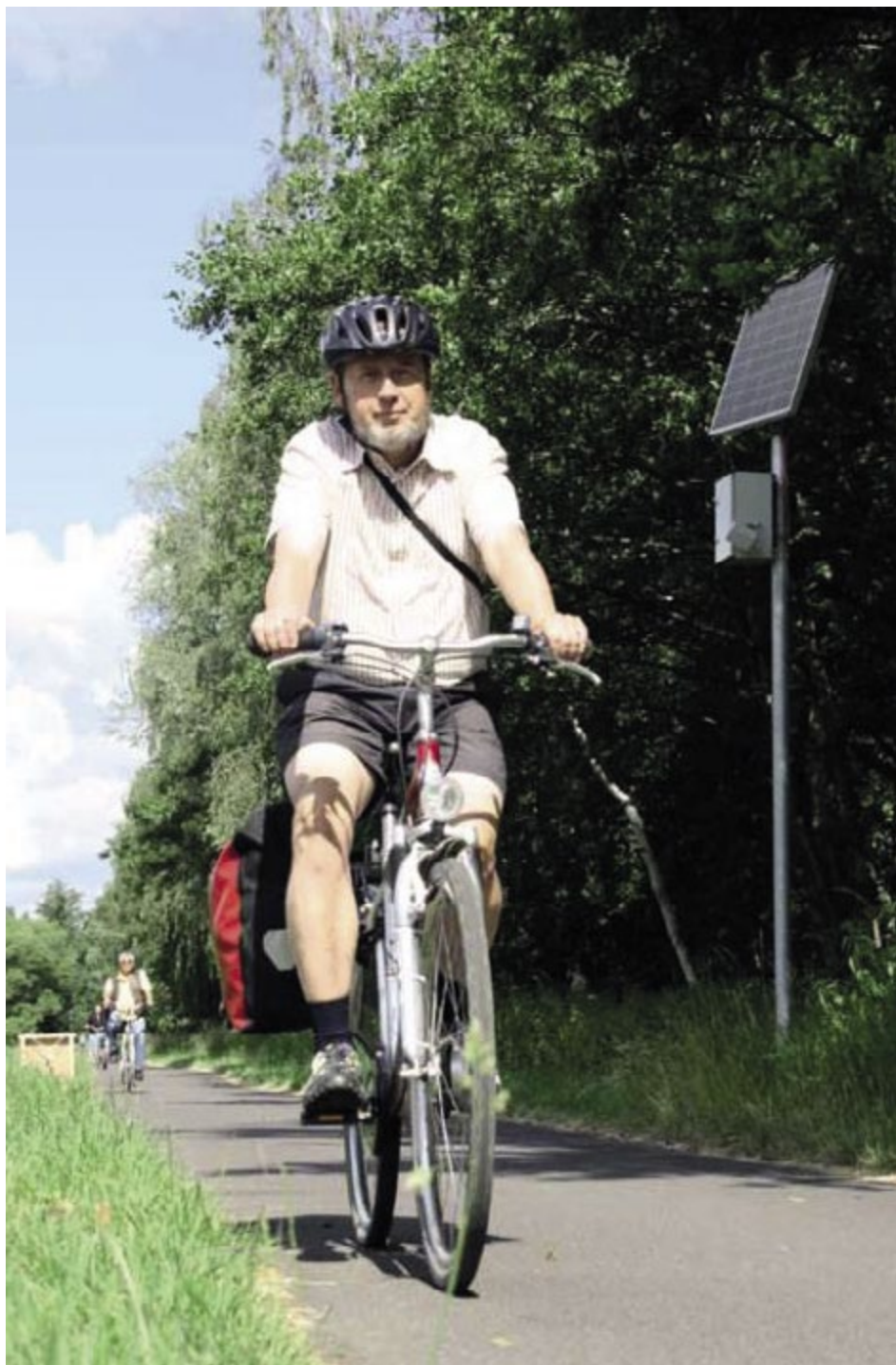
Radzählstelle mit Solarpaneel (Quelle: Radschlag, 2011)
